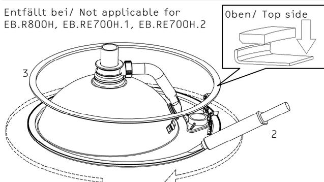
3. Kleber umlaufend, abdichtend auftragen (Dosierspitze um 30 mm kürzen). Zur Beschleunigung der Aushärtzeit Kleber mit Wasser besprühen. Styroporing einlegen und andrücken.
