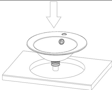
5. Klebefläche entstauben und entfetten. Becken in Trägerplatte einsetzen. Frische Klebstoffreste können mit Alkohol entfernt werden. **Nicht mit Aceton, Verdünnung oder Benzin reinigen!**
