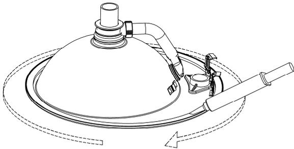
4. Kleber umlaufend, abdichtend auf Styroporring auftragen. Zur Beschleunigung der Aushärtzeit Kleber mit Wasser besprühen.
