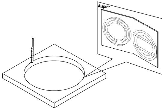
1. Für Becken-Ausschnitt beiliegende Schablone verwenden. Das Ausschnittsmaß steht auch unter [www.alape.com](http://www.alape.com) zum Download bereit.
