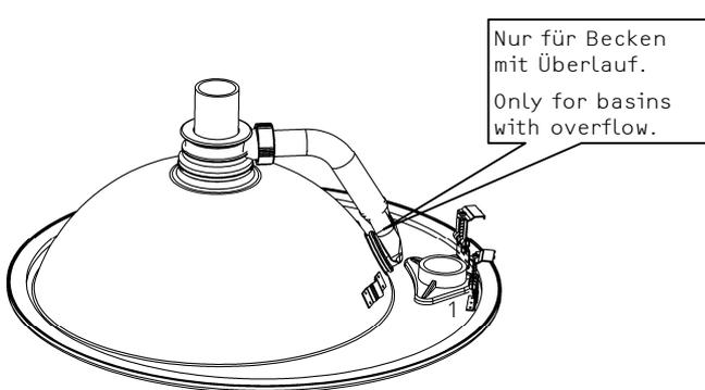
2. Ventil, ggf. Überlauf (optional Überlaufgarnitur ÜG.1 bei Modell EB.R800H) und Klammern am Einbaubecken montieren. Armaturenmontage auf Becken: Verwendung der Hahnloch-Unterlegscheibe (1) ist zwingend erforderlich!
