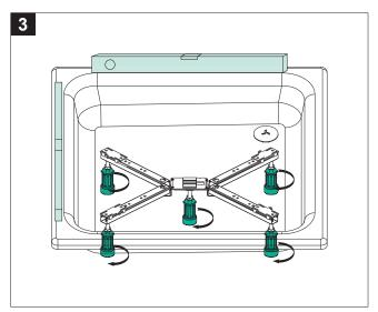
Zum Einjustieren nicht diagonal einjustieren, sondern die beiden Seiten der Duschwanne nacheinander in Waage bringen. Danach Mittelfuß beidrehen und alle Kontermuttern festziehen.
