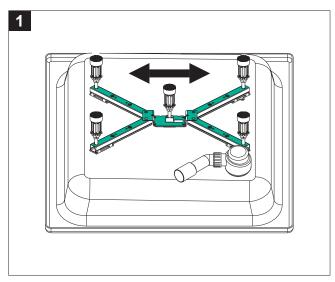
Kontermuttern der Höhenverstellungen lösen und den Duschwannenfuß auf die Duschwannengröße einstellen. Dazu können die Traversen geschwenkt und die Verbindungsplatte am Mittelfuß ausgezogen werden.
