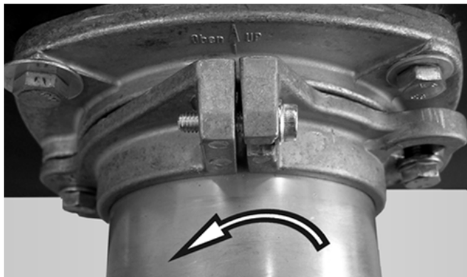
Abb. 4: Brennerbefestigung
