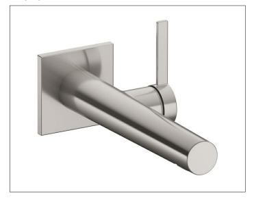
für UP Montage, DN 15, mit eckiger Rosette, Mischwasserkartusche mit keramischen Dichtscheiben Luftsprudler SLIM SSR M 24x1, Strahlwinkel verstellbar Durchflussbegrenzung auf 7,6 l/min. passend für Grundkörper Art.-Nr. 59916 000075 geräuschgeprüft
