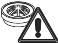
**Achtung: Der eingesetzte Durchflussbegrenzer darf nicht entfernt werden! Bei Nichtbeachtung erlischt die Gewährleistung/Garantie!**
