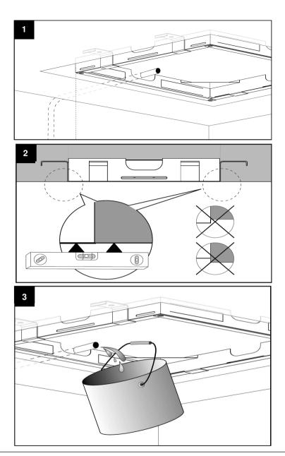
**Montagehinweis:** Beachten Sie die Rahmengrößen auf Seite 7. Bei nachträglicher Montage gelten die angegebenen Ausschnittmaße. In diesem Fall, ist der Spalt zwischen Ausschnitt und Rahmen bauseits zu verschließen. Beim Einbau in eine Massivdecke die Haltelaschen des Einbaurahmens entfernen.
