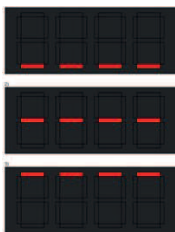
Fig. 59: Pumpenentlüftung beim 7-Segment Display
