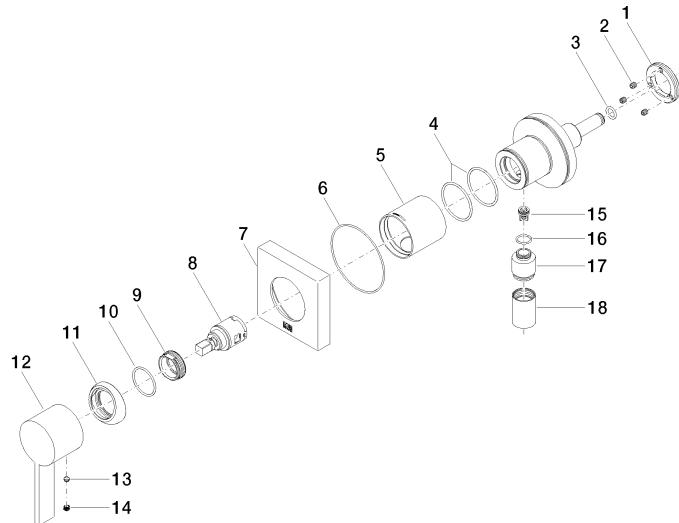
**UP-Einhandbatterie mit Abdeckplatte mit integriertem Brauseanschluss -
