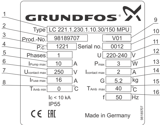
Abb. 9 Beispielhaftes Typenschild der Steuerung LC 221
