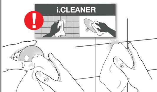
**DE** Klebefläche der Montageplatte und die Fliesenfläche gründlich mit dem Reinigungstuch i.CLEANER reinigen.
