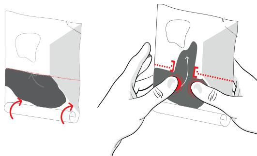
**DE** Klebstoffkammer umfalten und den Klebstoff in Richtung der schmalen Reaktionskammer drücken, bis die Trennnaht aufplatzt.
