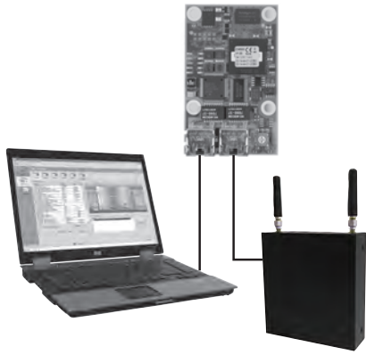
Mit dem PC und Mobilfunk-Router verbundenes CIM 500
