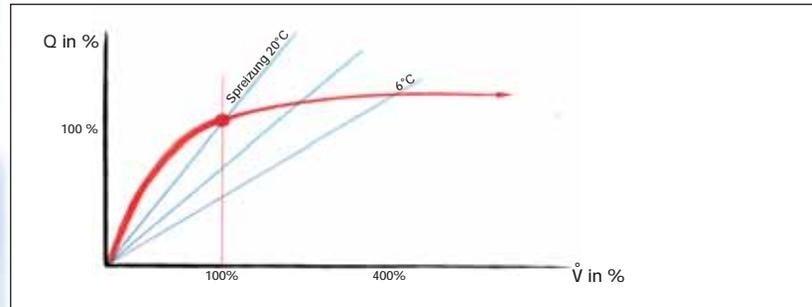
Durch ein nicht voreingestelltes Ventil fließt leicht ein Vielfaches der erforderlichen Wassermenge. Nur durch die Sicherstellung der geplanten Spreizung mit voreinstellbaren Ventilgehäusen RA-N kann die eingesetzte Primärenergie optimal genutzt werden.
