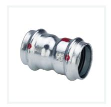
Prestabo-Muffe mit SC-Contur - Pressanschlüsse Ausstattung Dichtelemente EPDM Modell 1115
