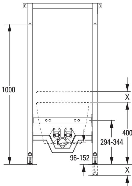
Bidéelementet är anpassat till en porslinshöjd på 400 mm. Om överkanten av porslinet ska hänga högre måste elementets fötter ställas in motsvarande före monteringen.
