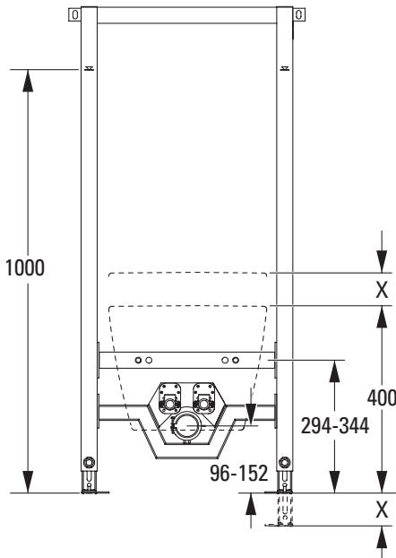
El bidé está adaptado a una altura de cerámica de 400 mm. Si el borde superior de la cerámica debe estar colgado más arriba, es necesario ajustar correspondientemente los pies del bidé antes del montaje.
