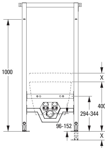
Element bidetu jest dostosowany do wysokości ceramiki 400 mm. Jeżeli górna krawędź ceramiki ma być powieszona wyżej, wówczas przed montażem należy odpowiednio ustawić stopki elementu.
