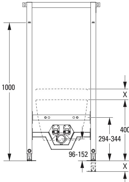
Pesuistuinlementti on sovitettu 400 mm:n istuinkorkeuteen. Jos istuimen yläreunan halutaan olevan korkeammalla, elementin jalkoja on säädettävä vastaavasti ennen asennusta.
