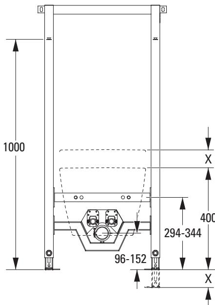
Bidotový prvek je upraven na výšku keramiky 400 mm. Pokud by měla být horní hrana keramiky zavřena výš, musí se před montáží příslušně nastavit nohy prvku.
