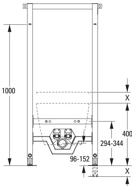
Монтажный элемент для биде устанавливается на керамической поверхности на высоте 400 мм. Если верхняя кромка керамики должна быть подвешена выше, основание монтажного элемента необходимо откорректировать перед началом монтажа.
