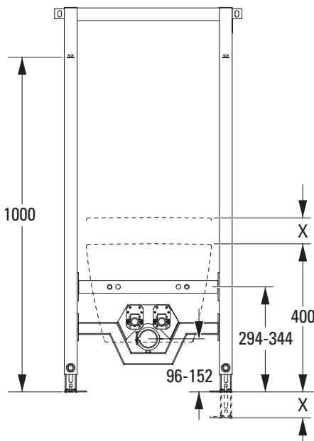
ビデ用フレームは、400 mm のセラミック高さに適合しています。セラミックの上端を高く吊る場合は、取り付け前にフレームの足を調整する必要があります。
