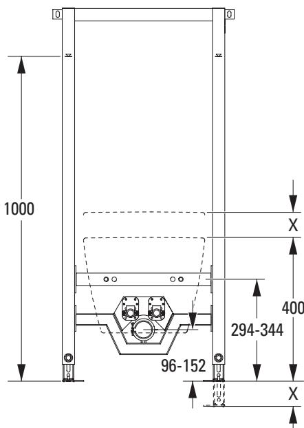
Елементът на бидето трябва да се напасне с височината на керамичната част от 400 mm. Когато горният ръб на керамичната част трябва да е по-висока, крачетата на элемента трябва да се регулират преди монтажа.
