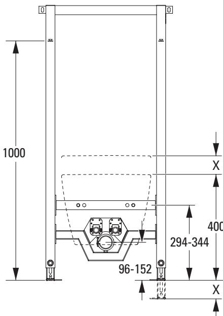
Bidē elements ir pielāgots 400 mm augstiem keramikas izstrādājumiem. Ja keramikas izstrādājuma augšējā mala atrodas augstāk, pirms montāžas attiecīgi jānoregulē elementa kājas.
