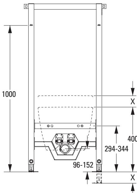
Het bidet-element is aangepast op een keramiek-hoogte van 400 mm. Als de bovenkant van de keramiek hoger moet hangen, moeten de voetjes van het element vóór de montage overeenkomstig worden ingesteld.
