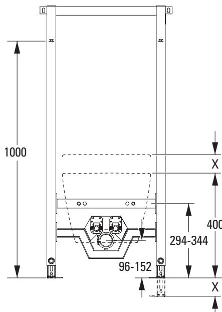
Das Bidet-Element ist auf eine Keramikhöhe von 400 mm angepasst. Wenn die Oberkante der Keramik höher hängen soll, müssen die Füße des Elements vor der Montage entsprechend eingestellt werden.
