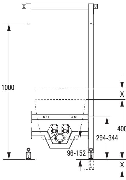
此坐浴盆元件陶瓷主体部分高度为 400 mm。如需将陶瓷主体上缘悬挂在较高位置，必须在安装前对元件的支脚进行相应的调整。
