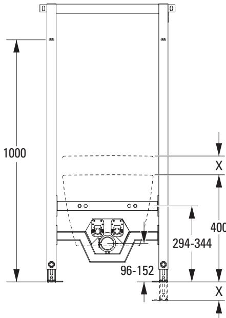
Bidet-elementet er tilpasset en keramikkhøyde på 400 mm. Hvis overkanten til keramikken skal henge høyere, må føttene til elementet stilles inn tilsvarende før montering.
