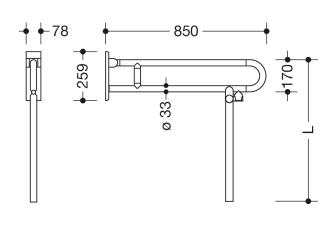
Abbildung ähnlich Abmessungen in mm
