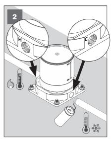
Heiß- und Kaltwasserzuleitung, entsprechend der Markierung an der Box, installieren (eindichten).
