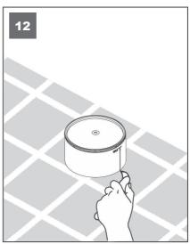
Nach erfolgter Fertigstellung des Bodenbelags, erfolgt die Anpassung des Kunststoff-Teils an das Bodenniyeau.
