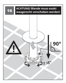
Festziehen mittels Inbusschlüssel. Blende zum Schluss bis auf den Boden schiehen.
