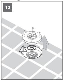
Entfernen der Abdrückvorrichtung. Die Dichtungen und Schrauben sind wieder zu verwenden! Achten Sie darauf, die Dichtungen nicht zu verschieben oder zu beschädigen.
