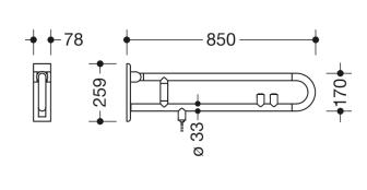
Abbildung ähnlich Abmessungen in mm
