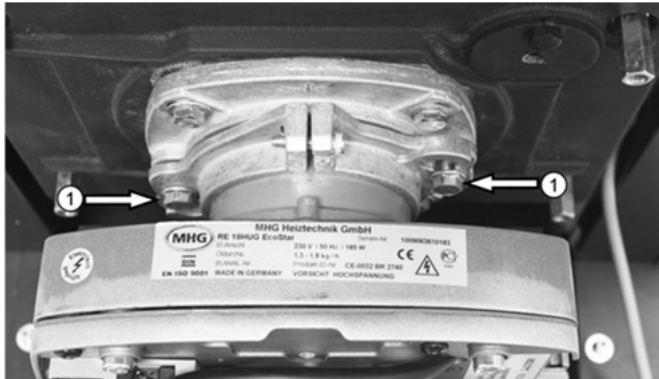
Abb. 30: Brennerbefestigungsschrauben
