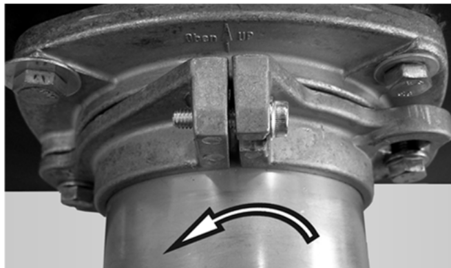
Abb. 4: Brennerbefestigung
